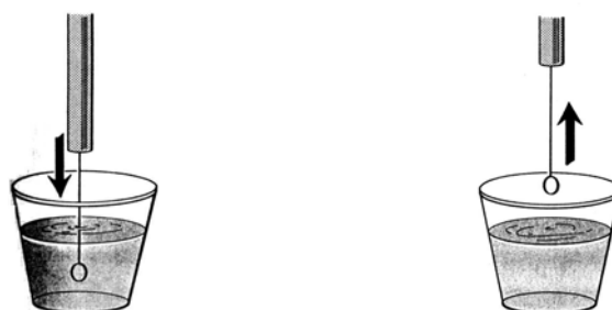
Figura 7a. Método para introducir el asa calibrada en la muestra de orina para asegurar que se retire una cantidad apropiada.
