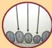
Baja tensión Superficial
