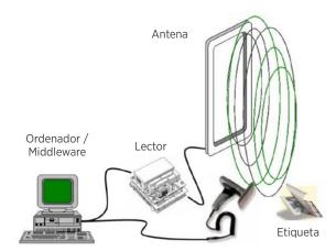
Es una identificación por radiofrecuencia, remota o inalámbrica de una etiqueta (tag) mediante una antena, que se conecta a un dispositivo lector, que a su vez transmite la información decodificada a un ordenador.
