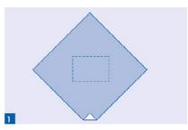
La bandeja con los instrumentos a esterilizar se coloca en el centro de la hoja de papel de manera que los bordes queden perpendiculares con las diagonales de la hoja de papel.
